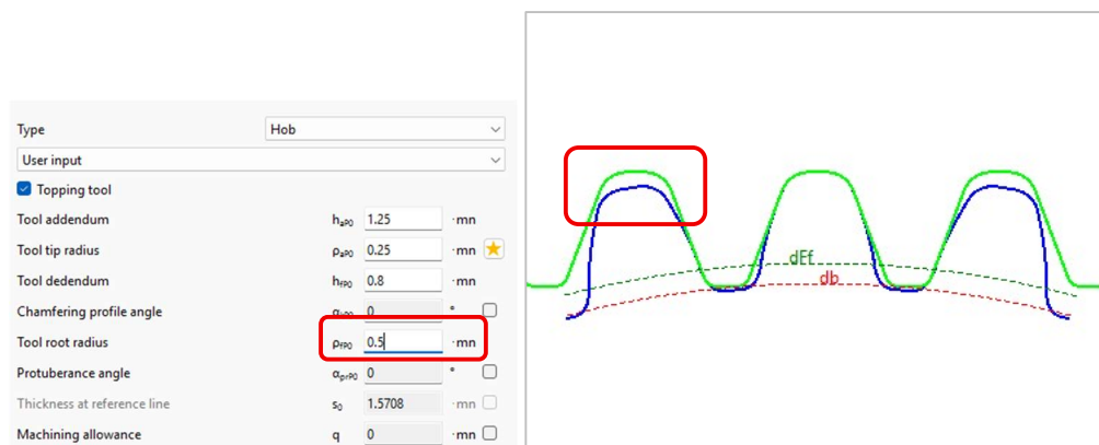
図 7-6 トッピングツール用にホブにおける歯元フィレットの定義。生成プロセスにより、歯車に歯先丸みが生成されます。
