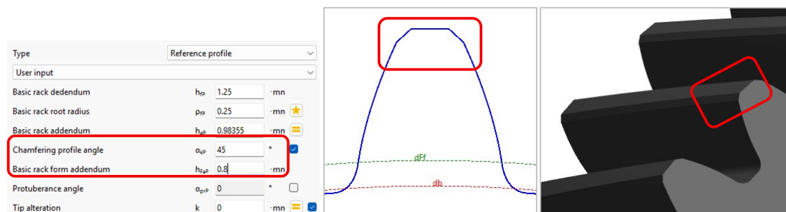
図 6-1 基準プロファイルによる歯先面取りの定義。
