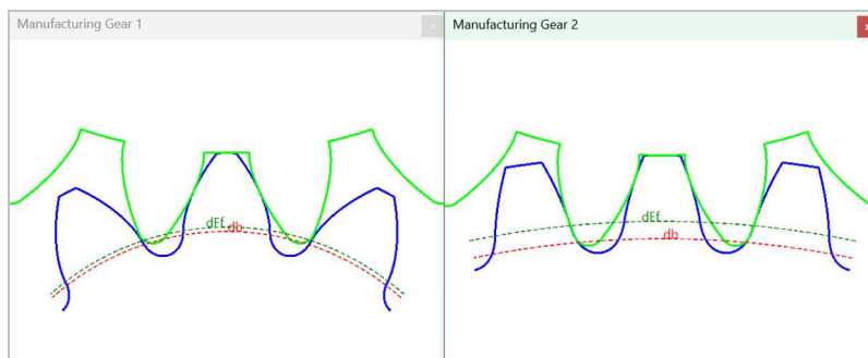
図 5-5 シェイパーカッターを使用した歯車 1 および歯車 2 の加工。
