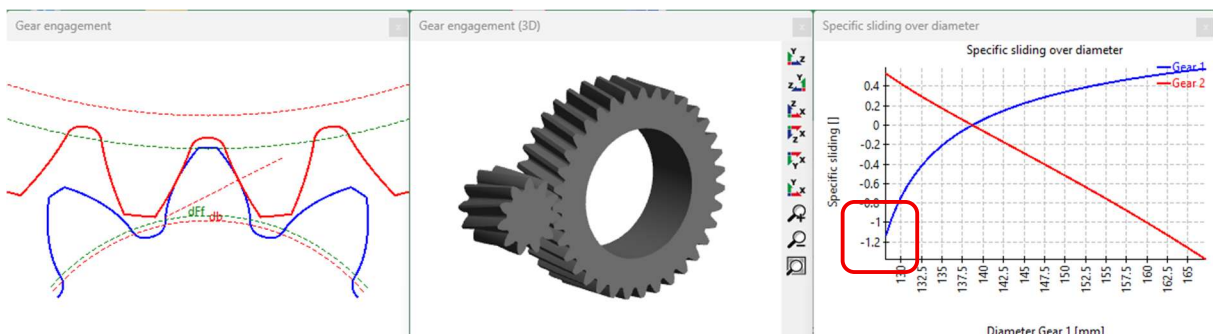
図 4-9 転位係数が最適化され、特定すべりが低い歯車。
