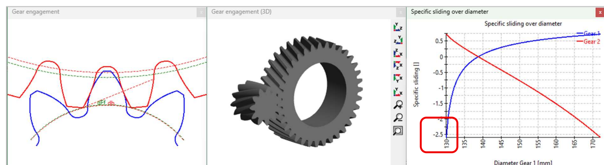
図 4-6 メニュー「グラフィックス/歯車かみ合い」、「グラフィックス/CAD/歯車かみ合い(3D)」からのグラフィックス、直径に対するすべり率。
