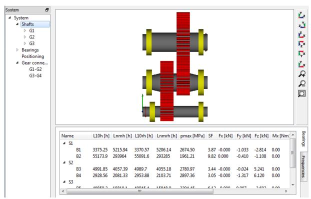
ギア対は、メッシュ剛性を考慮してライン荷重とみなされます。 歯車の幅にわたる荷重分布は、必要なフランクライン補正のヒントを提供します。
