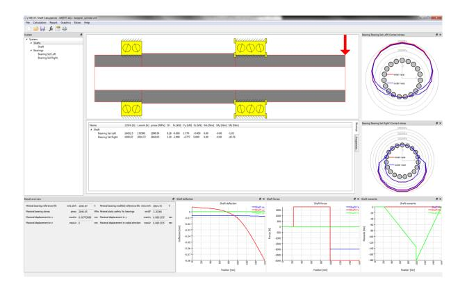
シャフト形状は、任意の数の円柱要素と円錐要素を使用して外径形状と内径形状を定義します。 ジオメトリ入力はテーブルを使用して行われます。
